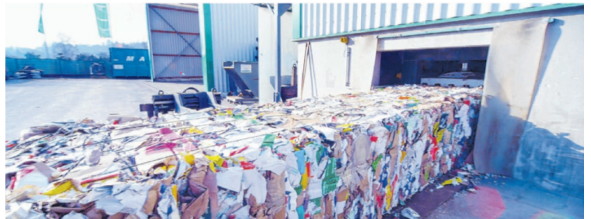
Beeindruckend: Die in der Halle untergebrachte Ballenpresse presst den Abfall in 600 Kilogramm schwere Ballen.
